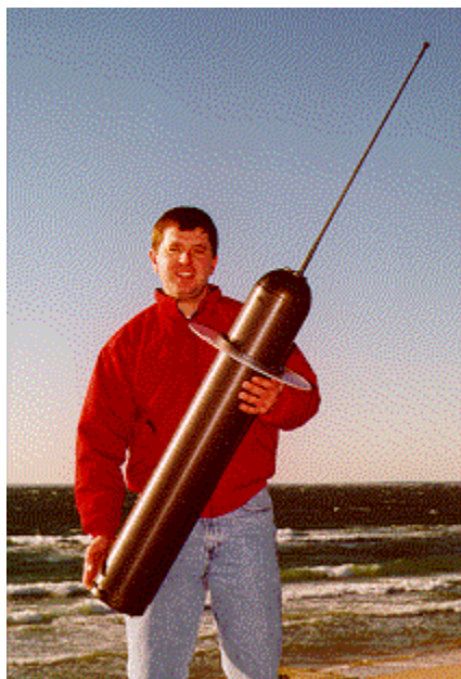
Figura 9. El ALACE es una boya de profundidad que periodicamente sube a superficie, donde es localizada por el sistema Argos. Figura extraída de la ARGOS Newsletter N° 49 de mayo de 1995.
