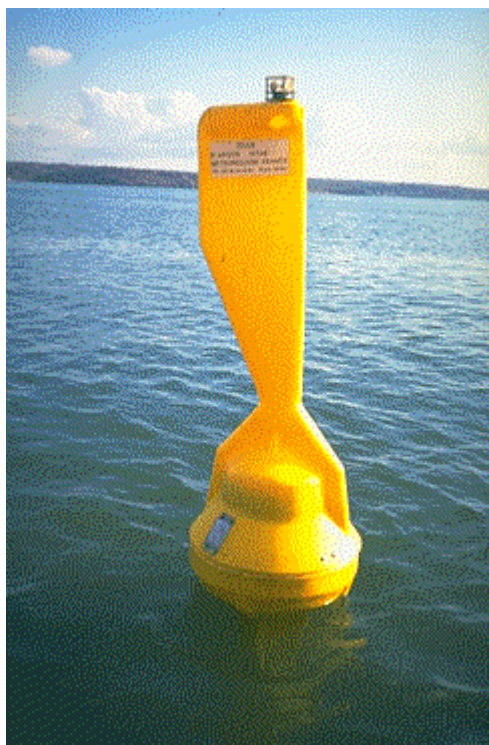
Figura 4. Boya a la deriva tipo FGGE para medir viento. El Servicio Meteorológico Francés (Météo France) despliega este tipo de boya denominada Marisonde GT en el Océano Atlántico Norte para medir presión de superficie, temperatura del aire, velocidad y dirección del viento y temperatura de la superficie del mar. Los datos se recuperan en tiempo real via el sistema Argos y se insertan en el Sistema de Comunicación Global (GTS) para uso en los modelos de pronóstico numérico del tiempo. Figura extraída de un sitio Web dependiente de la NOAA.
