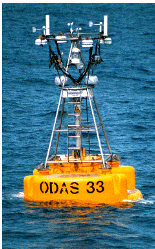
Figura 6. Boya denominada SEAWATCH fabricada por la empresa OCEANOR de Noruega. Es una boya con múltiples sensores que miden parámetros meteorológicos, oceanográficos, de olas y de calidad del agua. Foto extraída de folletos publicados por la empresa OCEANOR.
